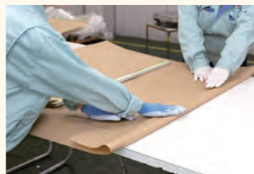
ハترون紙と呼ばれる大きなサイズの紙で、製品を包装しています。
